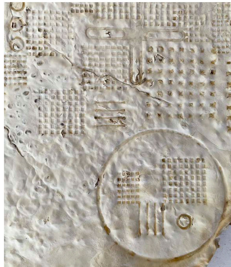
144. kép Az első tisztán, már szubsztrát nélkül dombornyomott felület, vastagsága 2 mm, felület mérete kb. B5 (2022)
