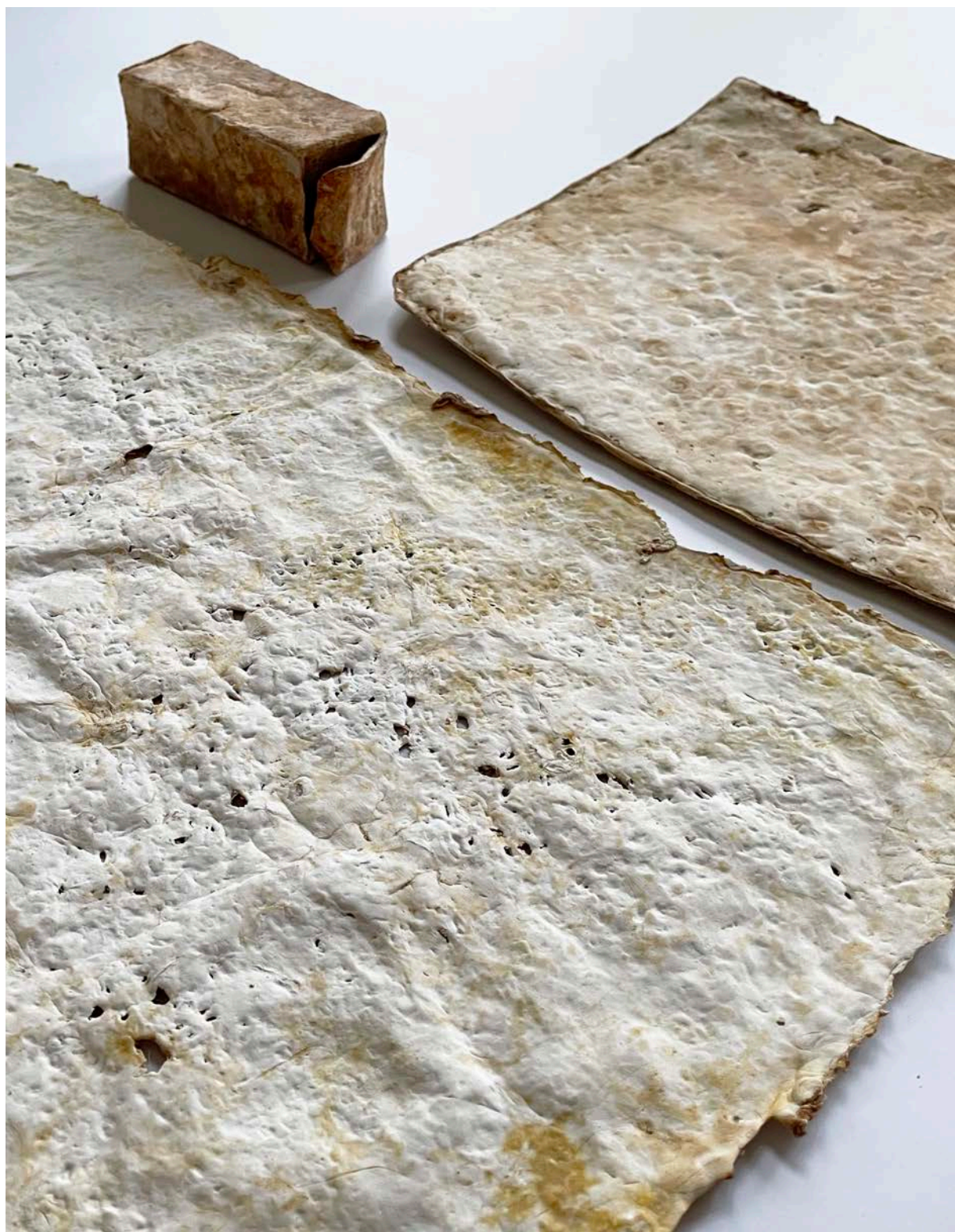
36. kép Mestermunka // FYP (Fungi Yielded Papers) materiális sorozat // Ganoderma lucidum myceliumból készített papír alapanyagok (2023)
