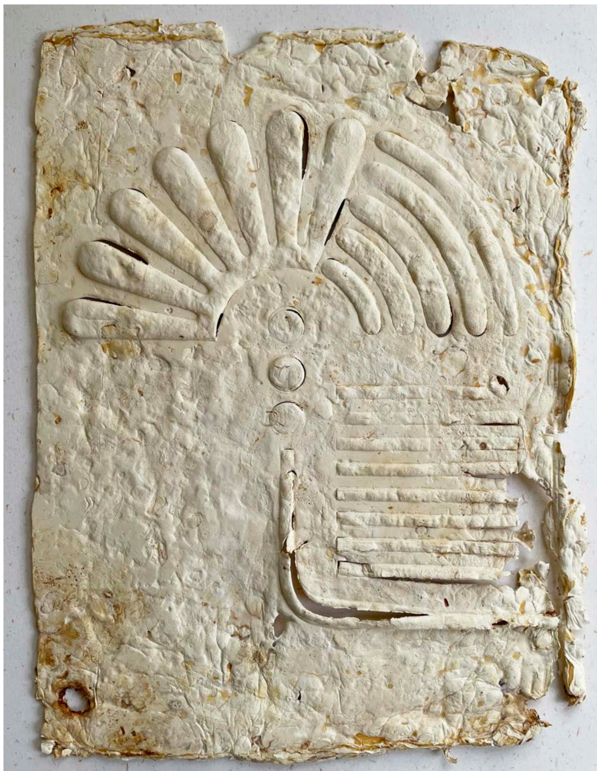
140. kép A szubsztrátról lefejtett, már dombornyomott felületű REISHI gombacsíra mycelium, kísérlet (2023)
