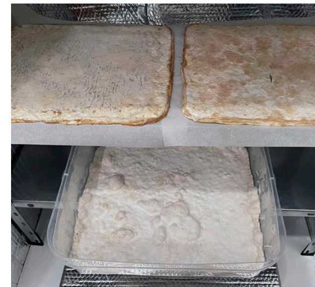
147-148. képek A szubsztrátról lefejtett különböző felületű és vastagságú mycelium lapok (2023)
