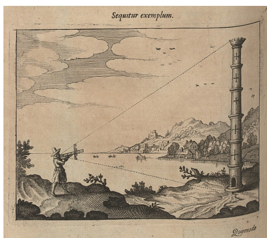
30. és 31. kép: Mérés vázlata egy Jákob botjával 66 és egy tengerészeti szextáns 67 .
