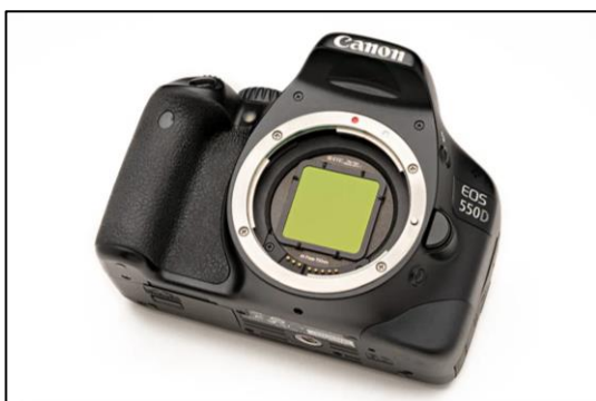
4. ábra – Egy Canon APSC vázba beillesztett szűrő.
