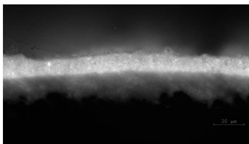
24. ábra - Az R7-es mezőből vett minta keresztmetszet-csiszolatának IR-L_VIS felvétele, 10x okulár, 20x objektív. Forrás: saját felvétel
