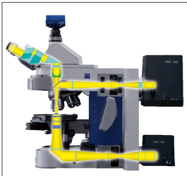
1. ábra - A Zeiss Axio Imager rendszerű polarizációs optikai mikroszkóp fényútjainak egyszerűsített ábrája (ráeső átmenőfényes vizsgálati típus egyaránt feltüntetve).
