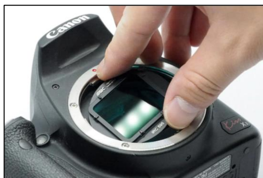
3. ábra - A szűrő behelyezése módja.
