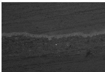
14. ábra – A modellkísérletekhez készült mintatábla R1-es szektorából származó minta, keresztmet-szet-csiszolatának felvétele, UV-R_UV 365 .
